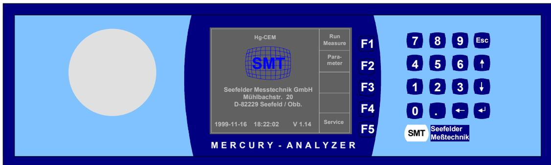
**Abb. 6 Frontplatte des Photometers**
